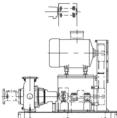
Насосный агрегат с опорной плитой, соединительной муфтой (также с проставком), ограждением муфты, стойкой, контрприводом, электродвигателем типа В3 и устройством для перестановки двигателя по высоте, ременной передачей и защитным кожухом ременной передачи
