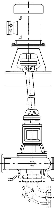
Насосный агрегат с вертикальной установкой со свободным концом вала со стороны двигателя для шарнирного привода вала, с опорной плитой для двигателя и насоса, несущей рамой, фонарем двигателя и входным коленом (**начиная с корпуса подшипника S05**)
