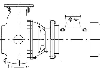
Насосный агрегат с непосредственно прифланцованным электродвигателем типа B5/V1
