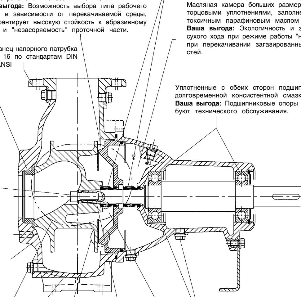
Запатентованная форма боковой полости у кромки рабочего колеса типа Е
