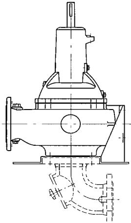
Насосный агрегат с вертикальной установкой со свободным концом вала со стороны двигателя для шарнирного привода вала, с опорной плитой и входным коленом (**для корпусов подшипников S01, S02, S03**)
