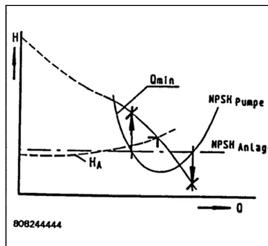
**1. Граница рабочего диапазона при работе в режиме частичной нагрузки при малой подаче**
