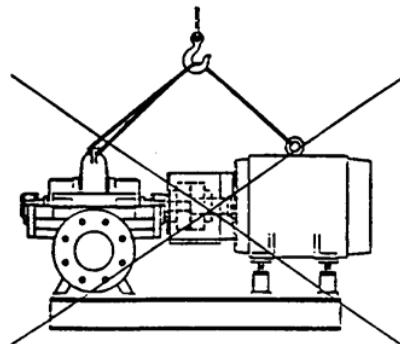
При поднятии с помощью крана необходимо проследить за углом наклона транспортных средств (троса, ленты).
