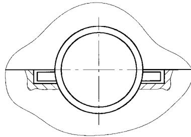
Корпус подшипников (350.1 и 350.2) закрепить на нижней части спирального корпуса (102), затянув до отказа винты с 6-гранной головкой (901.4).
