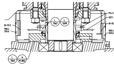
Перед монтажом верхней части спирального корпуса (102) обе разделительные поверхности должны быть тщательно очищены. На разделительной поверхности нижней части корпуса согласно Монтажной инструкции следует нанести покрытие из жидкого герметика - равномерно, без пропусков в виде тонкой пленки.
